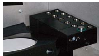
Werkzeugwechsler für 10 Fräser
