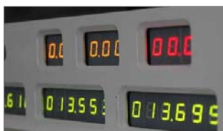
Automatische Kalibrierung mit 5 µm Genauigkeit nach jedem Starten
